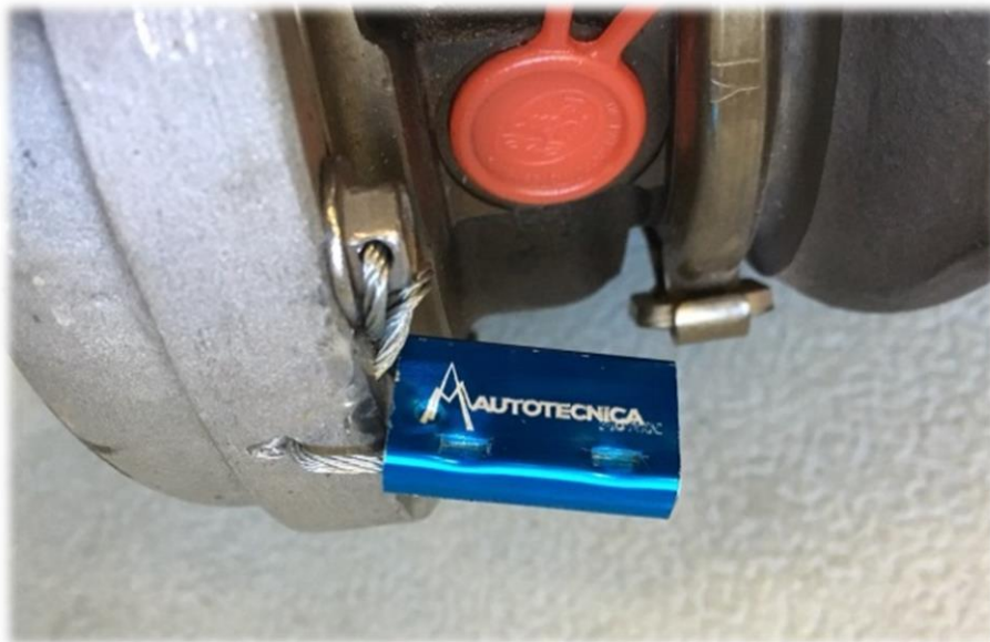
Fig. 1 : turbo sigillato con sigillo meccanico BLU
